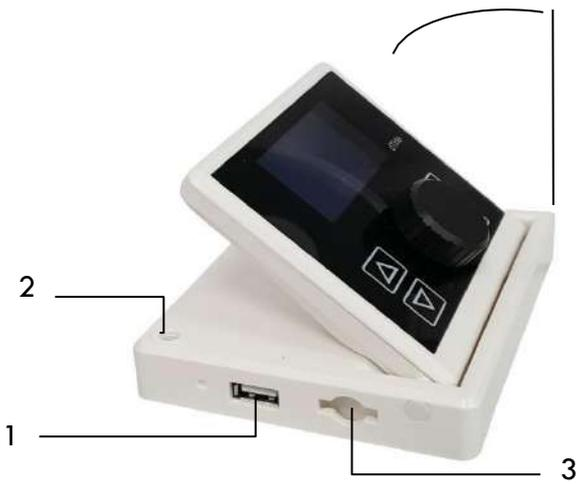
1. **Port USB** : connexion à l'agitateur magnétique
