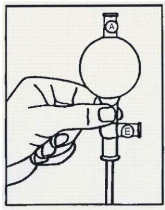
**3. Entleeren durch Druck auf das E-Ventil**
