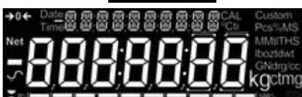
Una volta che un adeguato periodo di riscaldamento è raggiunto e si è pronti ad iniziare la pesatura, mettere l'elemento da essere pesato sulla bilancia. Un simbolo √ di stabilizzazione viene mostrato quando la bilancia è stabile. Si spegne se la bilancia non è stabile.
