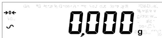
L'écran affichera la lecture du zéro avec le symbole du zéro « **→0←** » et la dernière unité de pesage utilisée. Si le calibrage automatique du temps est activé, la balance se calibrera 15 minutes après la mise sous tension, ou à nouveau après l'intervalle de temps prérglé
