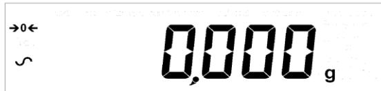
Il display mostrerà zero con il simbolo “**→0←**” e l'unità di pesatura utilizzata per ultimo. Se la calibratura automatica a tempo è abilitata la bilancia calibrerà 15 minuti dopo l'accensione, o dopo l'intervallo di tempo prefissato.
